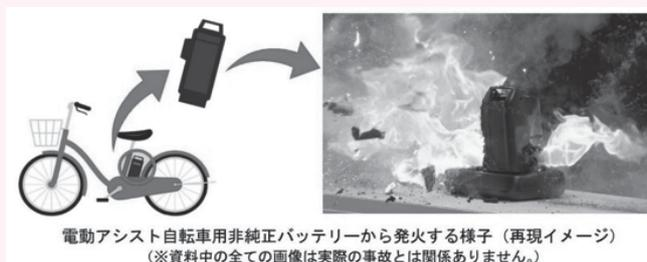
電動アシスト自転車用非純正バッテリーから発火する様子（再現イメージ）
